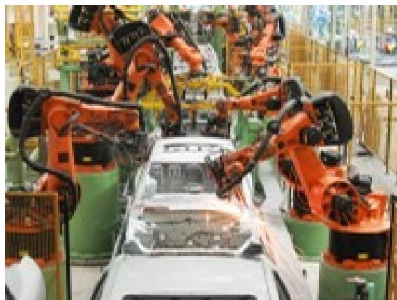
Figura 1.1: Linha de solda robotizada utilizada na indústria automobilística (Fonte: <http://www.philpem.me.uk/elec/welder/>; acesso em 31/07/07)
